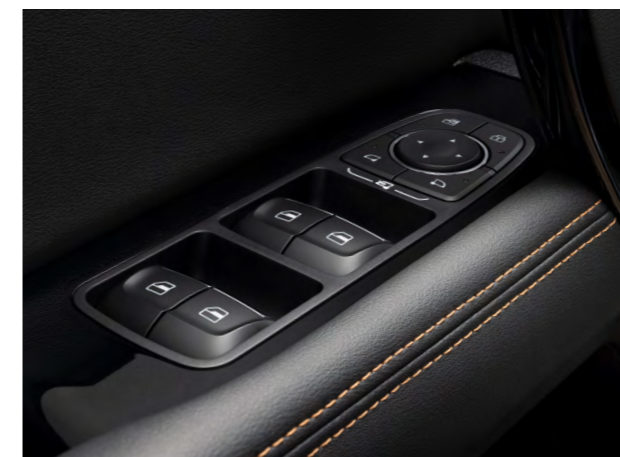
Электростеклоподъемники с автодоводчиком четырех дверей и функцией защиты от заземления
