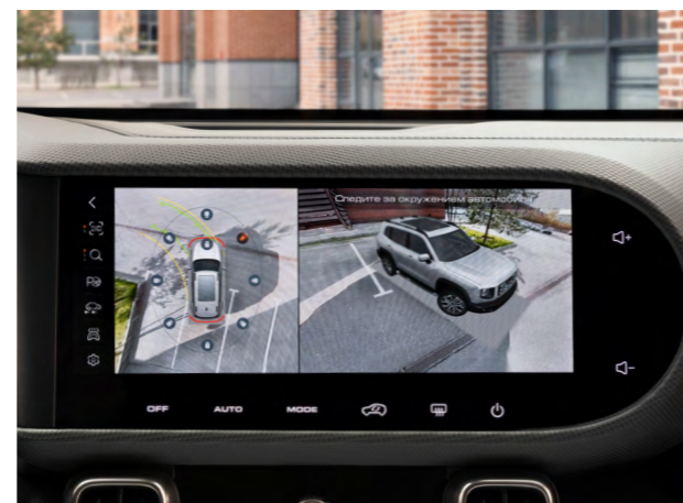
Система камер кругового обзора 360°
