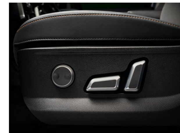
Электрорегулировка сиденья водителя в 8 направлениях
