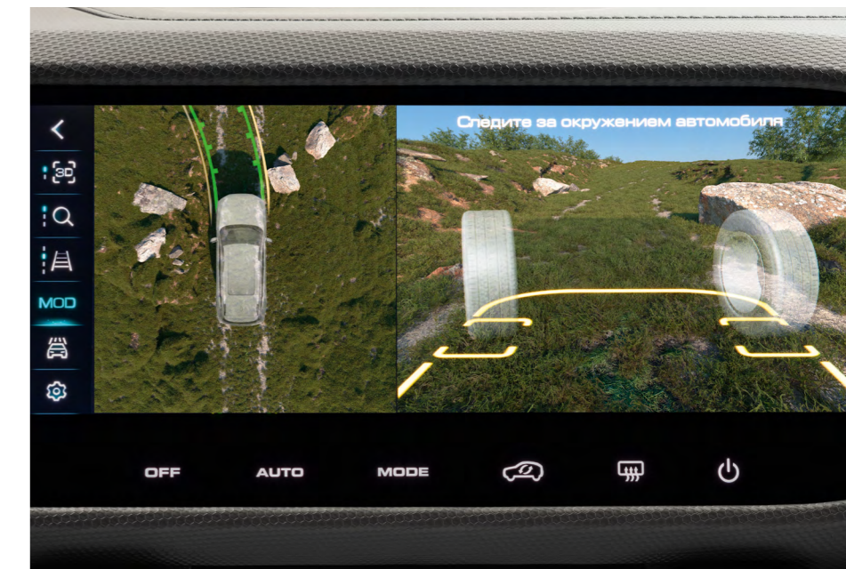
Функция также показывает угол поворота передних колес
